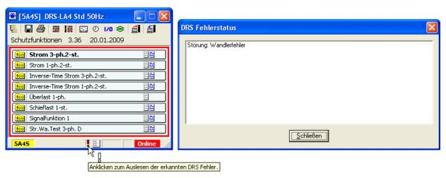
Abb.2 Anzeige einer Störung im Bedienprogramm DRS-WIN4
