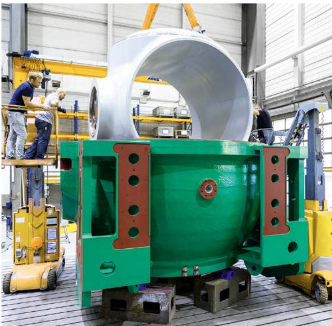
Montaje del rotor dentro del cuerpo de la válvula
