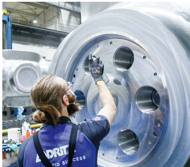
Inspección de grietas en las superficies de sellado del rotor de la válvula
