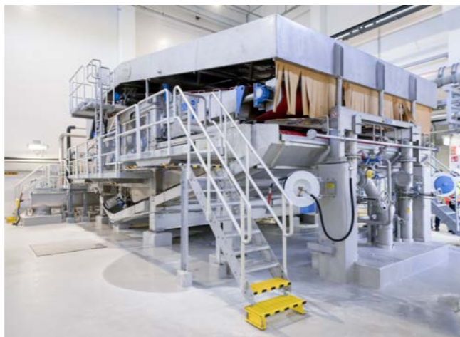
安德里茨双网压榨已经在所有浆料类型的众多应用中得到了很好的证明，它是在闪急干燥之前最适合的浓缩设备。
