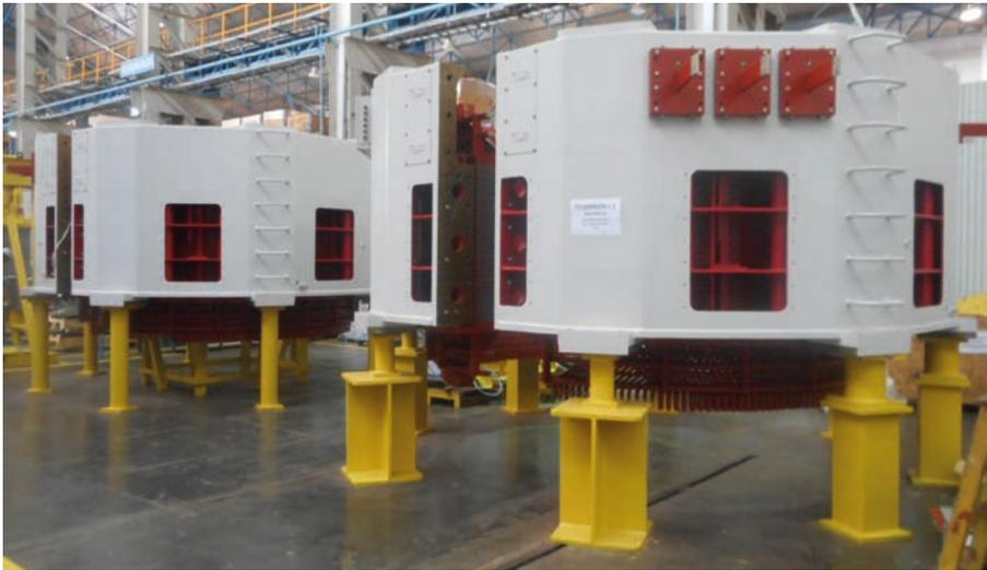
Assemblage du stator
